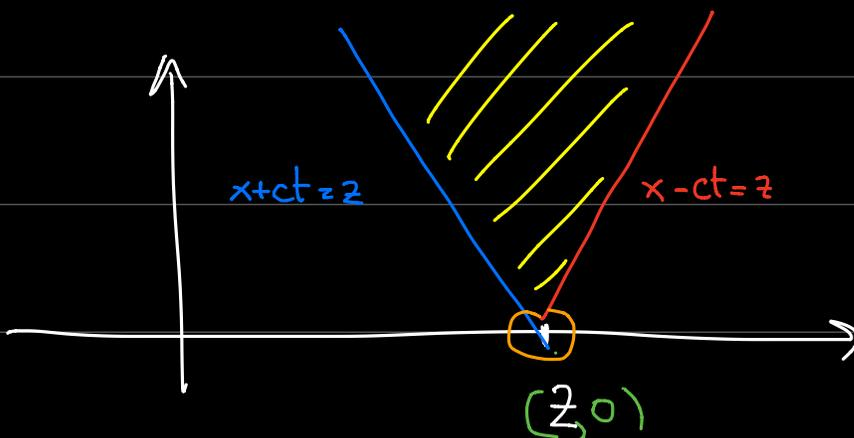
Questo significa che il segnale viaggia con velocità  $c$  lungo le caratteristiche  $\gamma_z^+$  e  $\gamma_z^-$ .
