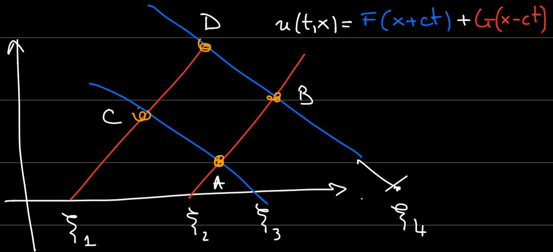
Parallelogrammo caratteristico ABCD
