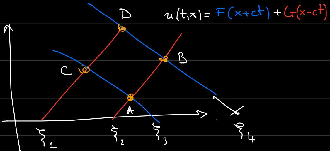
Parallelogrammo caratteristico ABCD
